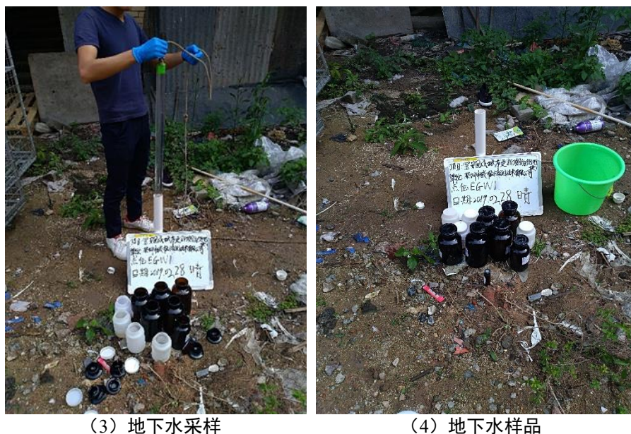
图 4-8 地下水现场采样过程
