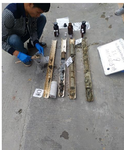
(5) 土壤重金属采样
